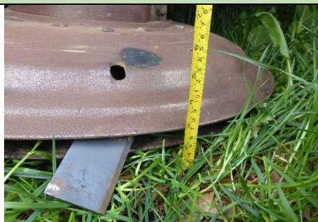
Durch ausreichende Schnitthöhe wird das Erntegut auf Stoppeln abgelegt und die Luft zirkuliert.
